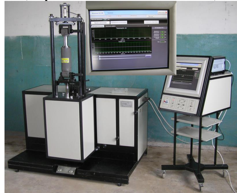
ИС-727/А [ИС-717/А, ИС-705/А] (гидравлические гасители колебаний)
