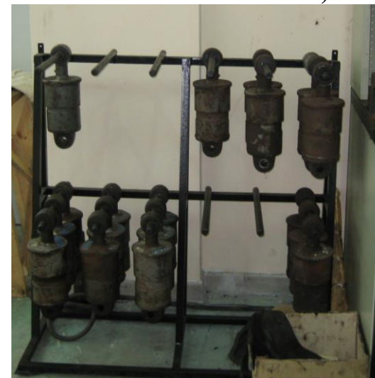
СН-403 (стеллаж-накопитель гидравлических гасителей колебаний)
