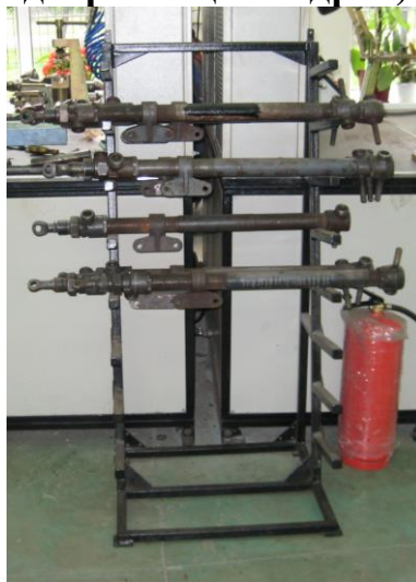
СН-402 (стеллаж-накопитель дверных цилиндров)
