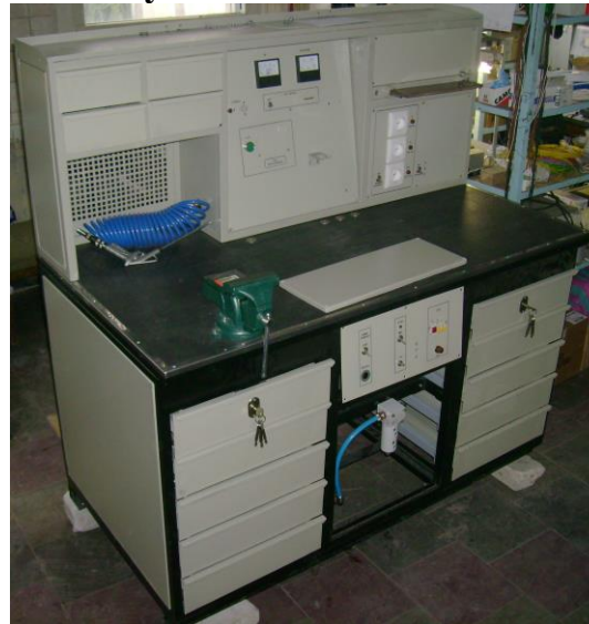
MP-125 (место рабочее слесаря аппаратного участка) с устройством для определения короткозамкнутых витков вентилей катушки.
